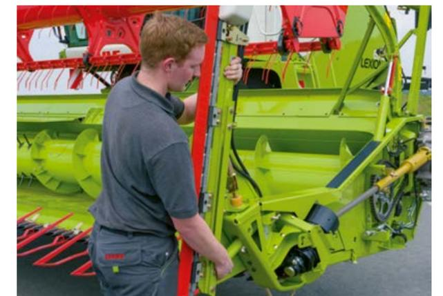
Установка рапсовых ножей с помощью быстродействующего затвора
