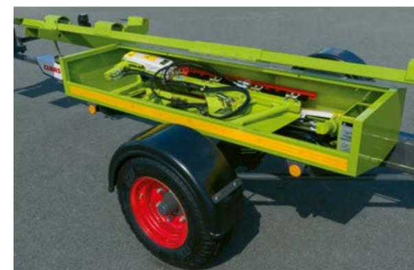
Запирающийся ящик для транспортировки оборудования для уборки рапса
