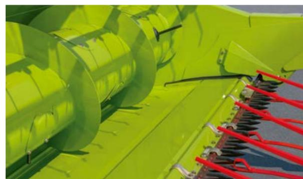
Стол жатки выдвинут – уборка зерновых (+100 мм)
