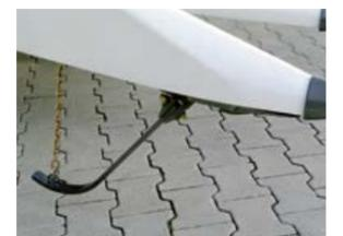
Скобы-копиры определяют положение жатки для AUTO CONTOUR и CONTOUR.
