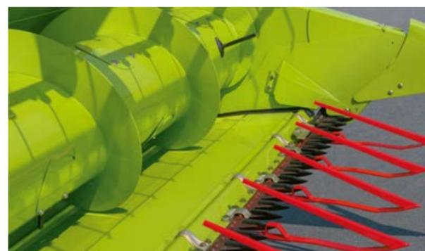
Стол жатки задвинут – уборка зерновых (-100 мм)
