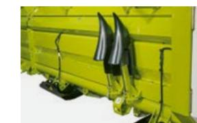
Положение навески на жатке для наконечника стеблелителя при транспортировке
