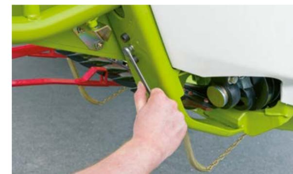
Простая регулировка стеблелделителя по высоте с помощью складного ключа
