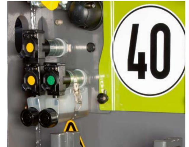
Гидравлические подключения в задней части с резервуаром и пневматической тормозной системой
