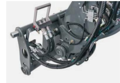
Гидравлические соединения на адаптере навесных орудий защищены стальной пластиной. Для быстрой и беспрепятственной смены орудия SCORPION в заводской комплектации может оснащаться многофункциональным разъемом.
