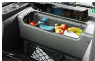
Напитки и сухой паек для длинного трудового дня можно хранить в охлаждаемом ящике за сиденьем механизатора.
