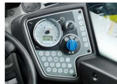
Выбранный диапазон и направление движения отображаются справа на панели приборов.
