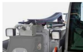
Дополнительное гидравлическое подключение простого действия, сверху на телескопической стреле
