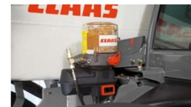
Система централизованной смазки для автоматического смазывания всех соответствующих точек
