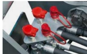
Два подключения двойного действия на адаптере навесного оборудования
