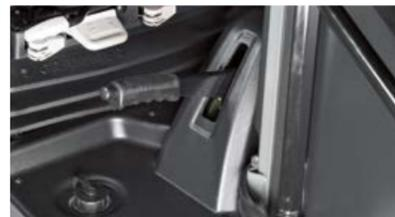
Механический ручной тормоз слева рядом с сиденьем на 3- и 3,5-тонных машинах
