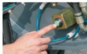
Очень просто – нажатием кнопки – осуществляется сброс давления в третьем контуре управления спереди на гибкой сцепке.
