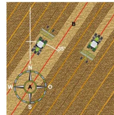
**Угловой режим А+ (передача опорной колеи).**
