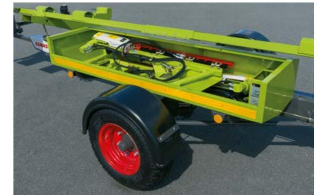
Ящик для транспортировки оборудования для уборки рапса
