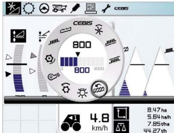
Регулировка частоты вращения ротора в CEBS
