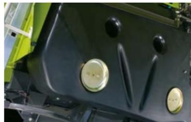
Топливный бак объемом до 750 л.
