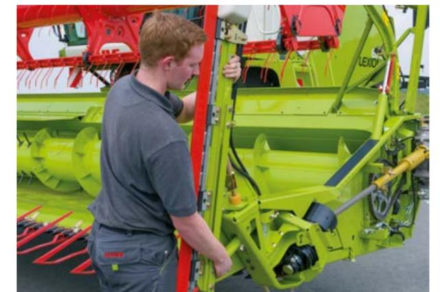
Установка рапсовых ножей с помощью быстродействующего затвора
