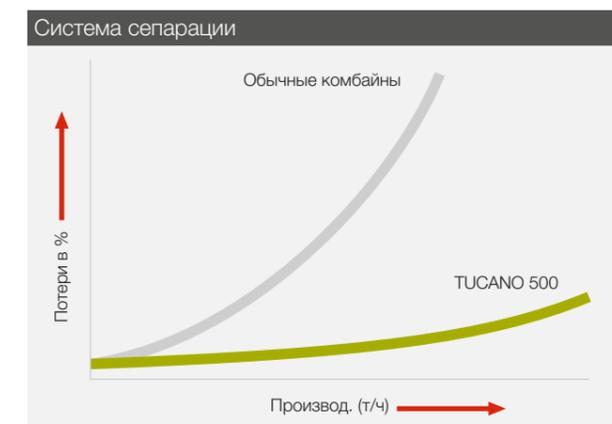
Начиная с определенного уровня производительности, потери при использовании обычных комбайнов резко повышаются, т. к. в данном случае система сепарации зерна выступает в качестве ограничивающего фактора. TUCANO 500 благодаря ROTO PLUS обеспечивает эффективную сепарацию зерна с сохранением допустимого показателя потерь.
