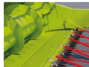
Стол жатки выдвинут – уборка зерновых (+100 мм)
