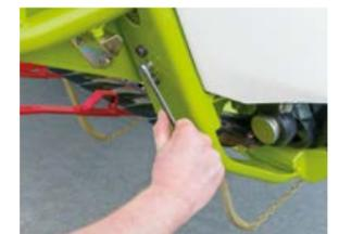
Простая регулировка стеблелделителя по высоте с помощью складного ключа
