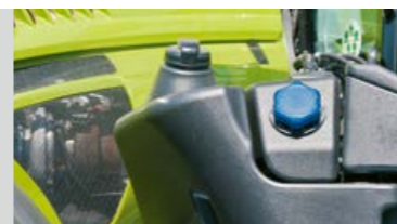
Топливный бак на 700 л с утепленным баком мочевины на 60 л
