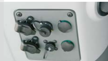
Разъемы питания (25 А, а также прикуриватель) и ISOBUS для дополнительных терминалов находятся под правой консолью.
