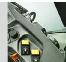
Установка рабочей глубины задней навески с помощью поворотного переключателя в подлокотнике
