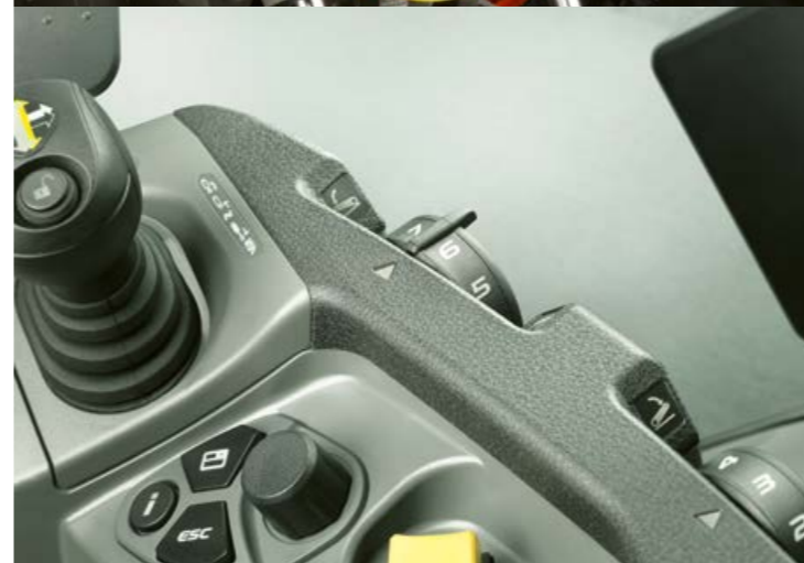
Внешнее управление для передней навески и одной секции гидрораспределителя
