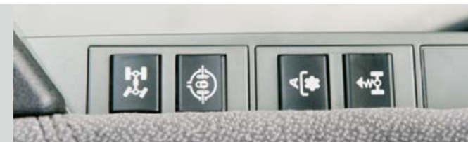
Панель управления (11) в подлокотнике: полный привод, блокировка дифференциала, автоматика вала отбора мощности и подвеска переднего моста
