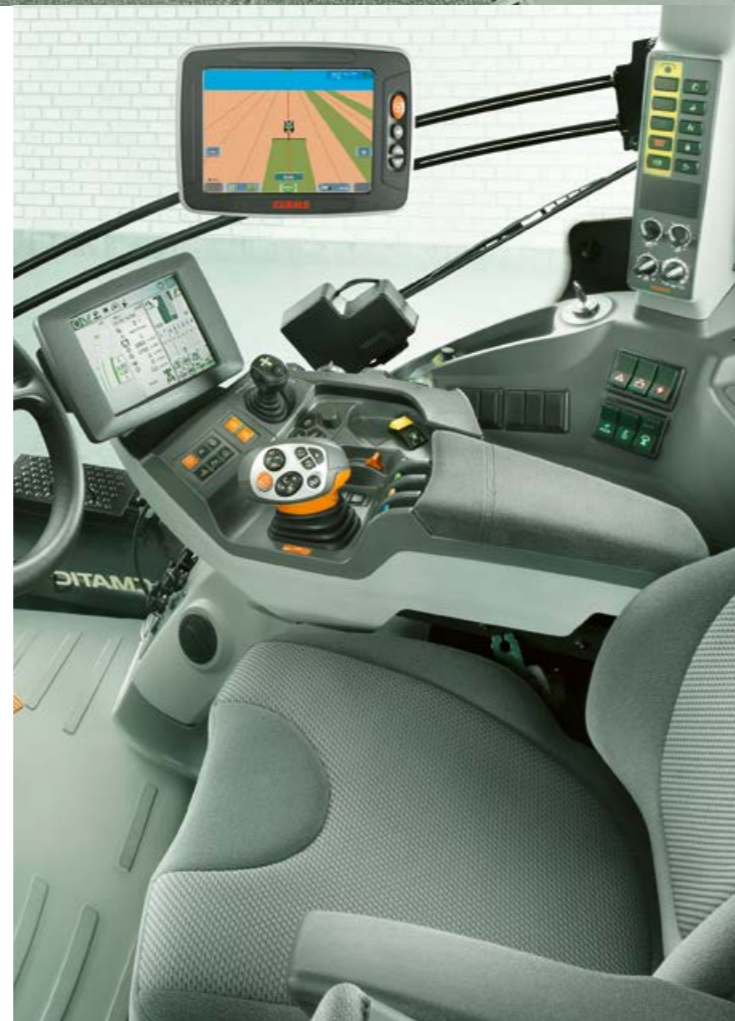
Панель управления (11) в подлокотнике: полный привод, блокировка дифференциала, автоматика вала отбора мощности и подвеска переднего моста
